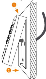
➤ Verrouiller l'appareil sur le support de fixation avec la vis de verrouillage.
