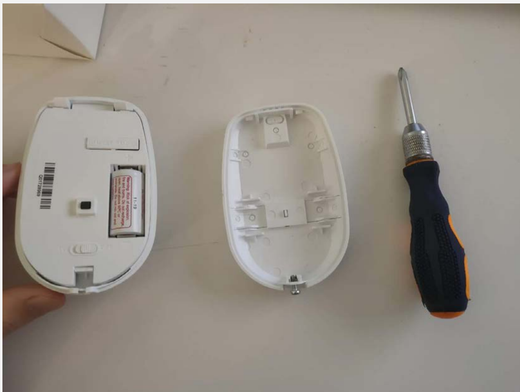
Ouvrir le PIR avec un tournevis
